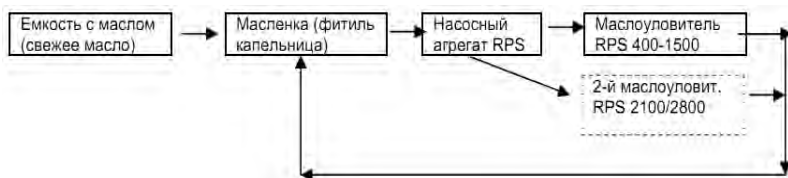
Рисунок 1.35 – Путь масла при циркуляционной смазке
