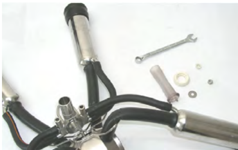
Рисунок 6.19 – Проверка прокладки коллектора
